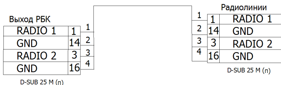
Рисунок 21 - Схема кабеля «Радиоблок» - «Sentinel ISA/CMS-420»
